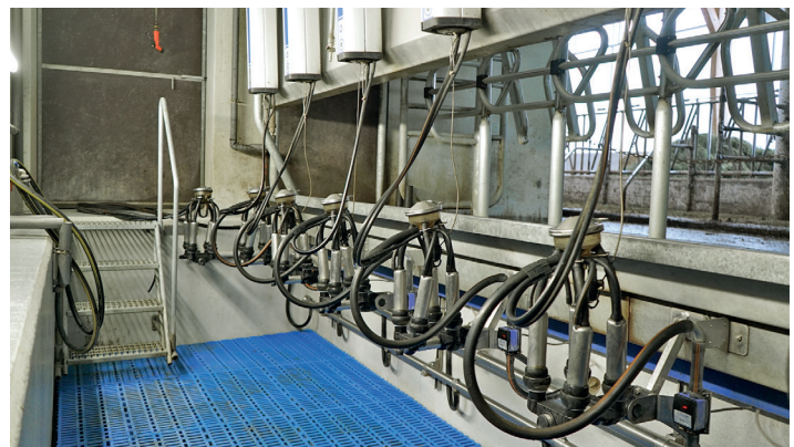
EIN DELAVAL-7ER-SIDE-BY-SIDE-MELKSTAND melkt die Milchkühe. Während des Melkens steht man auf einem trockenen Kunststoffrost.
